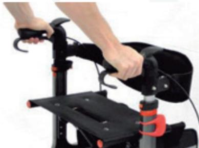
El efecto del freno depende de qué tan fuerte se presionen los frenos. Use el freno de estacionamiento empujando las manijas del freno hacia abajo hasta que encajen en su lugar con un clic audible. Para aflojar el freno de estacionamiento, jale las manijas del freno hacia arriba.
