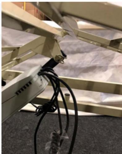
El accionador de plegado de la sección de las piernas debe montarse debajo del marco de la cama de modo que el extremo del motor (el extremo donde los cables se conectan al accionador) esté hacia el centro de la cama y el ariete extensor del accionador esté conectado a la sección móvil de plegado de la sección de piernas de la plataforma del colchón.
