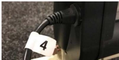
Todos los cables ya deben estar conectados a la caja de control y numerados del 1 al 4 con una etiqueta en el extremo opuesto donde se conectan a cada accionador. El número dentro de la caja de control (círculos arriba) debe corresponder con el mismo número en el otro extremo de cada cable.
