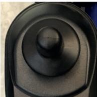
La dirección de desplazamiento de la silla de ruedas es controlada por un joystick. La extensión móvil del joystick también controla la velocidad de movimiento.
