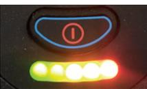
Después de encender la alimentación, el indicador de energía de la batería está funcionando. El indicador de energía de la batería también muestra la capacidad de energía restante de la batería.
