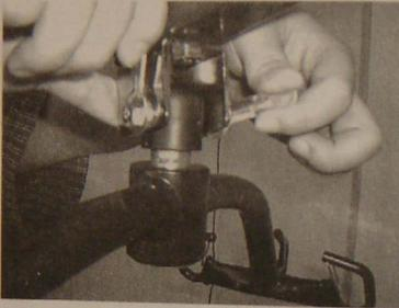
7.- Quite el tornillo de la parte superior de la barra de separación, teniendo cuidado de no dejar caer junto con el pasador. Instale la barra de separación con el soporte en forma de U en el extremo de la pluma. Alinee los agujeros, inserte el perno y apriete.
