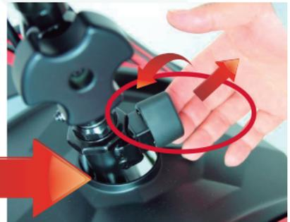
9. Bloquee la rueda delantera y el manubrio girando y tire del bloqueo de la rueda hacia abajo.
