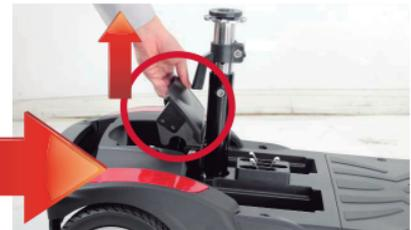
10. Tire del dispositivo de conexión hacia arriba hasta la sección trasera y manténgalo en posición vertical.
