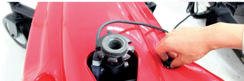
**Paso 4:** Coloca el asiento levantando la manija en el lado izquierdo del asiento y colocando el asiento hacia abajo en el tubo del asiento. Suelta el asa y gira el asiento de lado a lado para asegurarte de que el asiento esté bloqueado y mirando hacia adelante.
