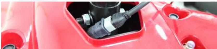
**Paso 10:** Carga completamente la silla de ruedas eléctrica insertando el enchufe de 3 clavijas en una toma de corriente estándar de forma directa y el conector del cargador redondo en el terminal de carga en la batería que se encuentra en la parte frontal del controlador.
