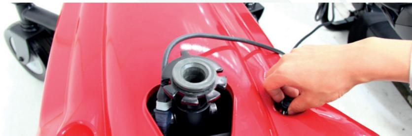
**Paso 2:** Conecta los dos conectores de la batería al cable principal. Los conectores de la batería son rojos y negros, y deben conectarse al arnés de color correspondiente del cable principal.
