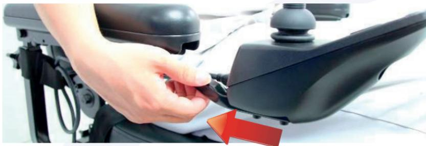
**Paso 9:** Conecta el cable del control al punto de conexión.
